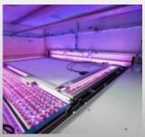
Симулятор солнечного света LS-72 – идеальный осветитель для поточного производства фотоэлектрических модулей и НИОКР. Близкая к идеальной имитация солнечного спектра обеспечивает точное измерение эффективности солнечного элемента при минимальных эксплуатационных расходах за счёт долговечности светодиодов. Благодаря длительному времени экспозиции и способности к световому насыщению, прибор идеально подходит для различных сфер применения в НИОКР. Светодиоды устанавливают новые стандарты!
